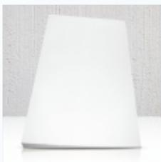
Um Wärmebrücken im Bereich von einbindenden Wänden und Decken zu verhindern, empfehlen wir den *epatherm*<sup>®</sup> Thermkeil (1000 x 600 x 40/5mm). Die Montage erfolgt analog der Wohnklimaplatzenverlegung. An Dachschrägen und Raumdecken wird generell geklebt und mit der Plattendübelfräse passgenau gedübelt. Nach dem fugenlosen Anspachteln an die vorhandene Oberfläche kann sowohl gespachtelt als auch geputzt werden (zweilagig mit vollflächiger Gewebeamierung).
