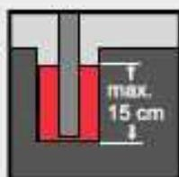
**OTTERFIX<sup>®</sup> Schnellbeton** einfach und ohne aufwändiges Anmischen zu verarbeiten. Schüttungen in Lagen von bis zu 15 cm in das vorbereitete Loch einstreuen und nach Ausrichtung des Einbauteils mit der erforderlichen Wassermenge angeießen.
